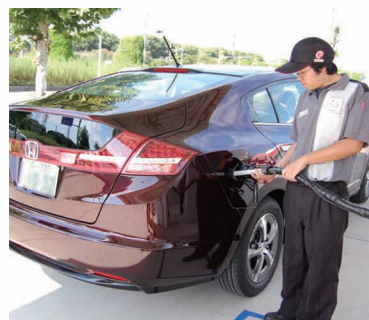
灯油から製造した水素を補給しています。
